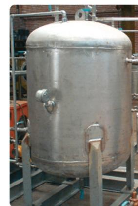
یکی از سیستم های اقتصادی و مفید برای بودار کردن جریان گاز می باشد که هدف از این فرایند غالباً ایجاد بوی تند و نفوذ پذیری در گاز است تا بهنگام حتی کوچکترین نشت گاز قبل تشخیص بوده و از ترکیب آن با هوا و بروز انفجار جلوگیری کند. از این نوع بودار کننده در ایستگاه هایی با ظرفیت  $m^3/h 20000$  پائین تر از استفاده می شود.
